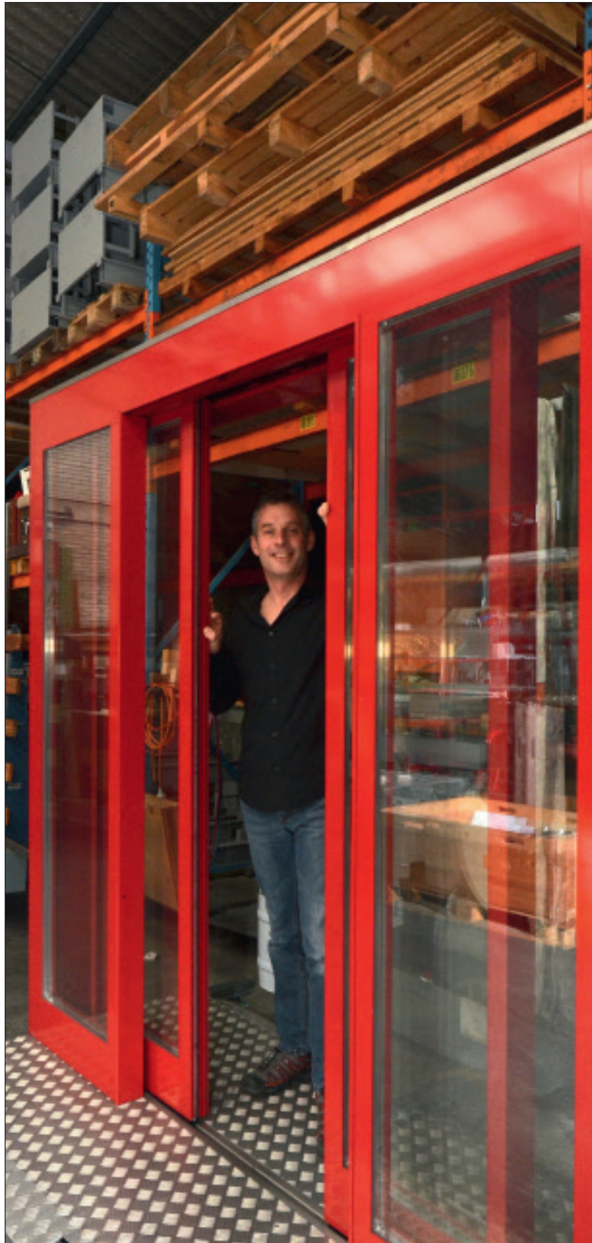
In der Manufaktur in Mellingen werden die automatischen Sicherheitstüren zusammengebaut und getestet, ehe sie vor Ort installiert werden. Fotos: bg
